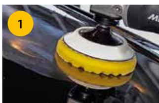
1 Используйте пасту Polarshine® 10 и желтый рельефный диск Mirka®. Протрите поверхность, затем окончательно очистите ее салфеткой Mirka. Полируйте со скоростью не выше 1500 об./мин.
