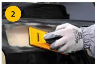
Понижение риски и расшлифовка границ. Используйте сетчатую полосу P180–P240 со шлифовальным блоком или машинкой Mirka® OS 383.
