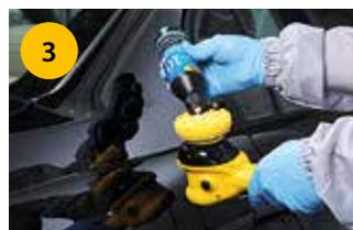
3 Для финишной полировки используйте желтый поролоновый рельефный диск Mirka® и пасту Polarshine® 10. Нанесите небольшое количество полировальной пасты на диск.
