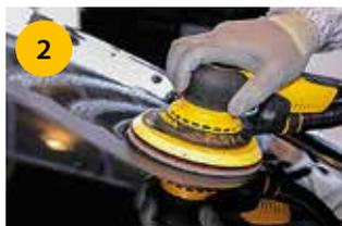
2 Понижайте риск, шлифуя абразивом Abralon® 3000 с водой. Шлифуйте на низкой скорости (6000 об./мин).
