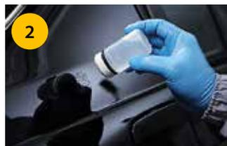
2 В процессе шлифования всегда смачивайте водой абразив и обрабатываемый участок. Используйте диспенсер-увлажнитель Mirka.
