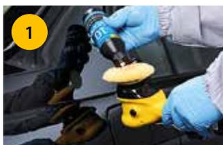
1 Используйте полировальную машинку Mirka® ROP2 312NV с меховым диском из овчины Mirka Pro и полировальной пасты Polarshine® 10.
