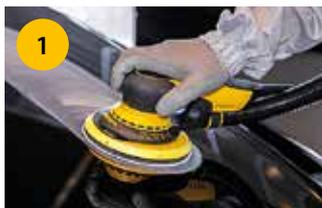
1 Удалите дефекты с помощью микроабразива Microstar® P1200 или P1500 и мягкой прокладкой 5 мм. Шлифуйте со средней скоростью (6000–7000 об./мин).
