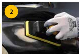
\*\*\* Проверьте обработанный участок. При необходимости заполните поры тонкой полиэфирной шпатлевкой.
