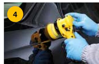
4 Полируйте на средней скорости с небольшим нажатием. Протрите и осмотрите поверхность. При необходимости повторите полировку. Для окончательной очистки используйте мягкую салфетку из микроволокна Mirka.
