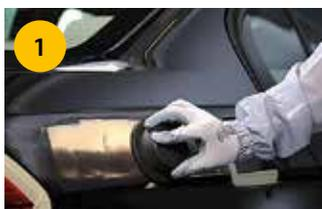
Нанесите сухое проявочное покрытие Mirka Dry Guide Coat для выявления неровностей поверхности.
