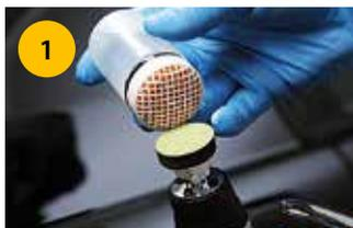
1 Для устранения дефектов используйте Polarstar® SR и машинку Mirka® AOS 130NV или Mirka® ROS 150NV.
