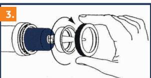
3. Снимите переднюю гайку с пистолета и закрепите картридж внутри пистолета.
